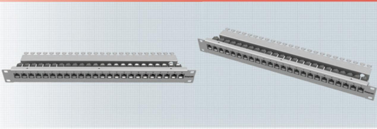
Das Verteilerfeld 19" 1HE ist beschaltbar mit bis zu 24 preLink® / fixLink® RJ45 Keystonemodulen. Das Verteilerfeld ist in zwei Ebenen aufgebaut. Somit sind die Module bündig in der Frontplatte. Das Verteilerfeld kann wahlweise in Edelstahl oder pulverbeschichtetem Eisenblech bestellt werden.
