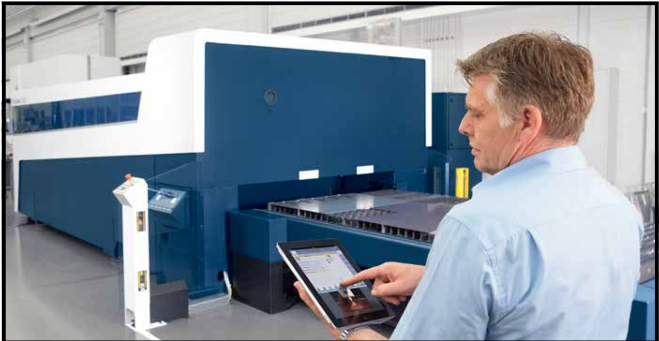
Mit der MobileControl App sind Maschinenbediener stets im Bilde und können die Anlagen auch dann steuern, wenn sie sich nicht in der Nähe des stationären Bedienpults befinden
